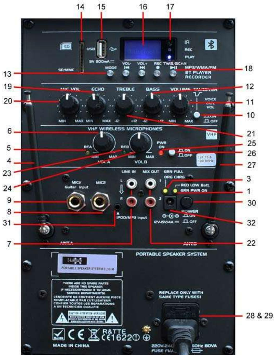
(1) POWER-Anzeige, leuchtet wenn die Soundanlage eingeschaltet ist.
